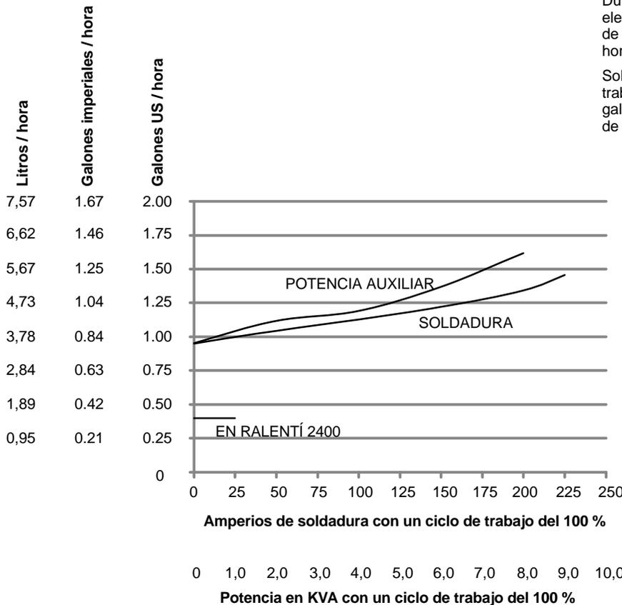
Durante un trabajo normal con electrodos 7018 de 1/8 pulg. (125 A, ciclo de trabajo 20 %), se estiman unas 20 horas de uso.
