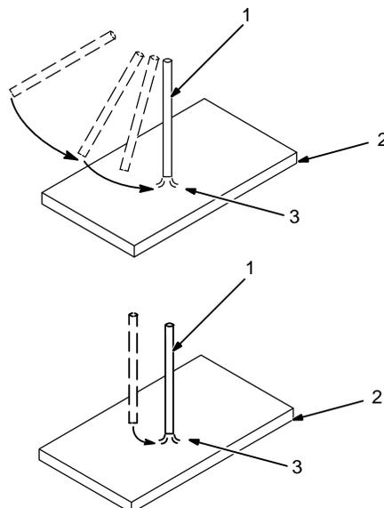
**⚠ La corriente de soldadura se establece cuando el electrodo toca la pieza.**
