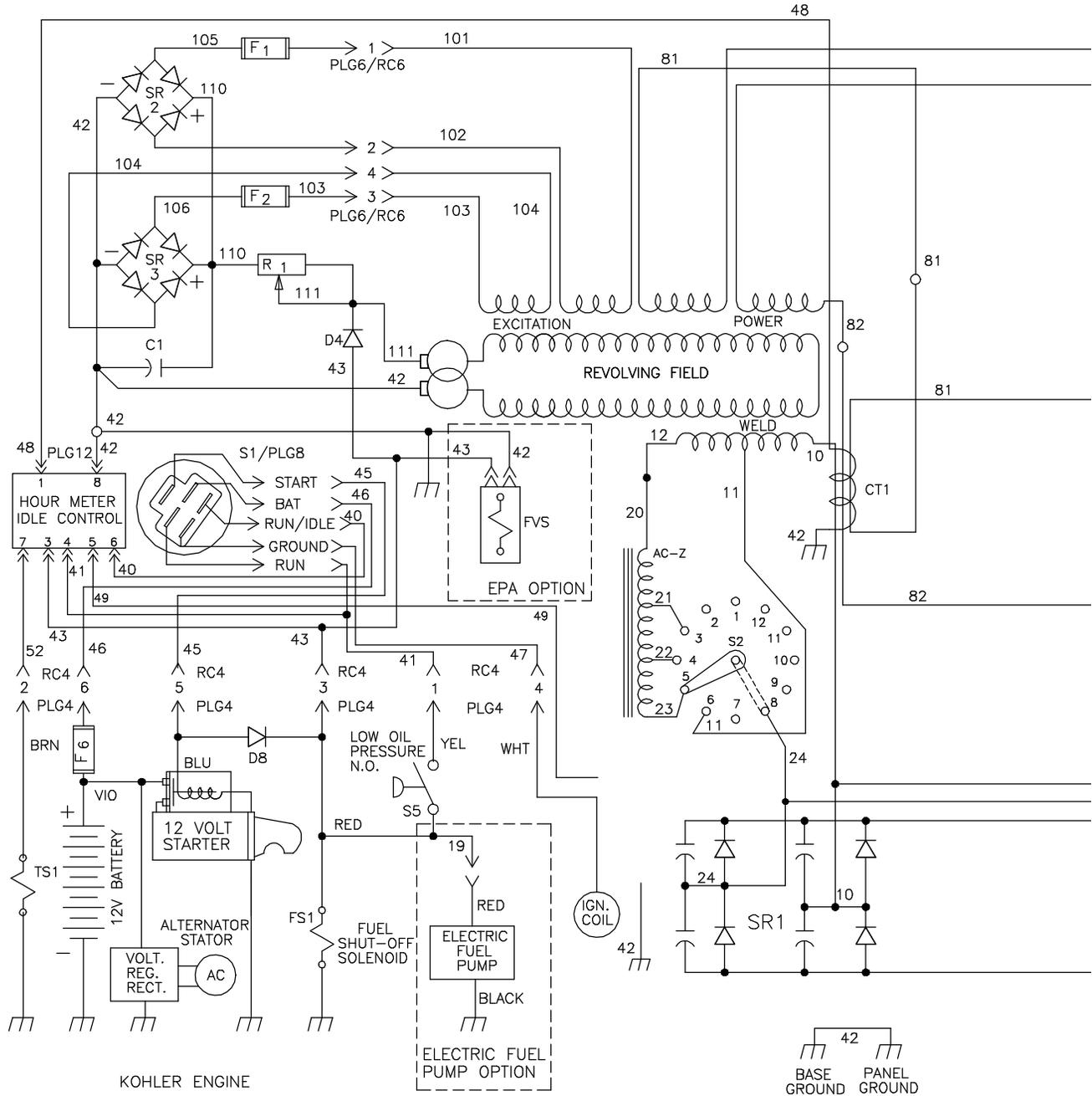
Ilustración 10-1. Diagrama de Circuito para el Generador de Soldadura
