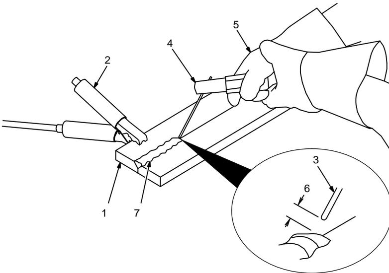
**⚠** La corriente de soldadura comienza cuando el electrodo toca la pieza de trabajo.
