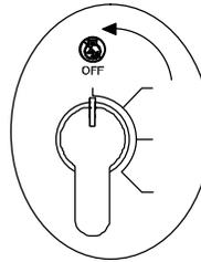
**⚠ Detenga el motor. Desconecte el cable negativo (-) de la batería.**
