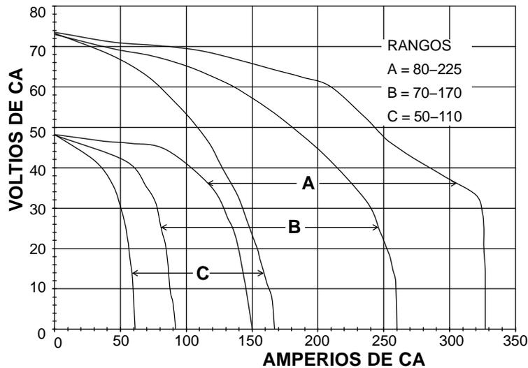
La curva voltio-amperio muestra los voltajes y las corrientes mínimos y máximos de la salida del generador de soldadura. Las curvas para otros ajustes caen entre las curvas indicadas.
