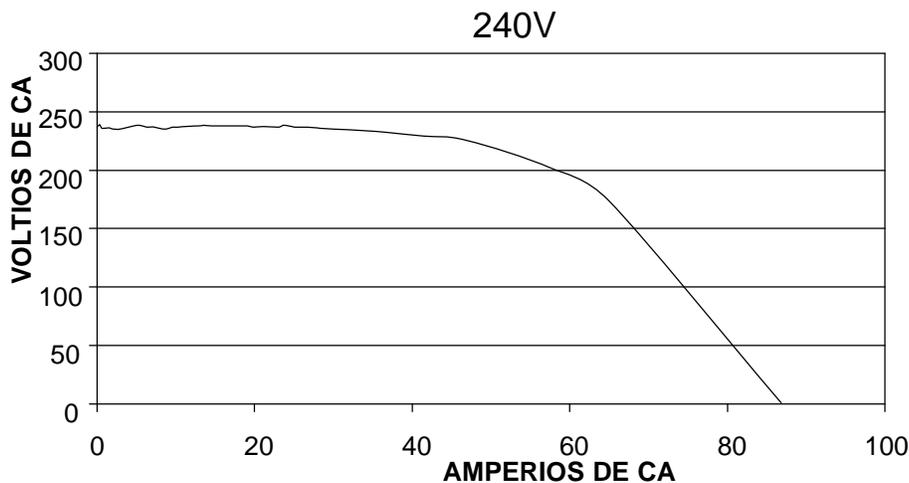
La curva de potencia del generador muestra la potencia del generador, expresada en amperios, disponible en las tomas de corriente.
