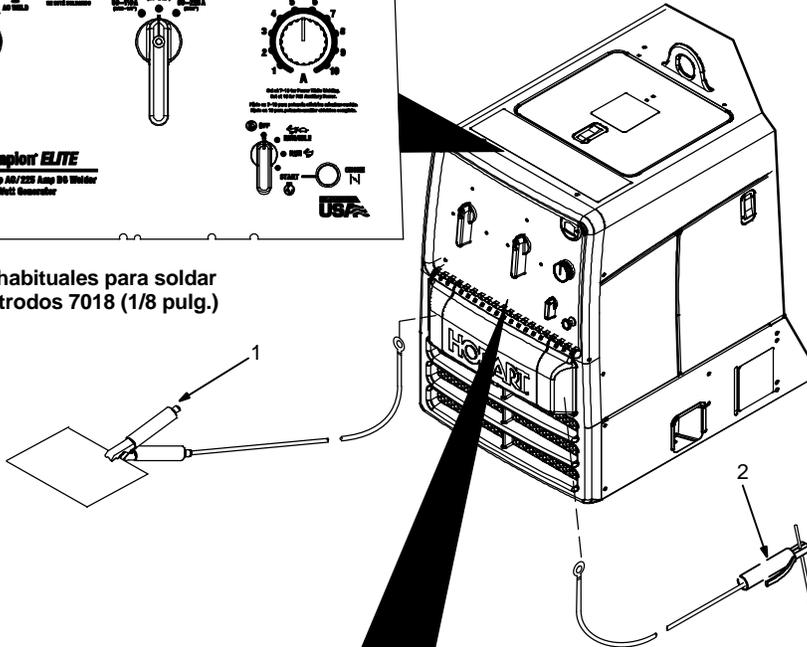
Para lograr un mejor arranque del arco y resultados más satisfactorios al utilizar simultáneamente la soldadura y el generador, use un ajuste grueso bajo y un ajuste fino en la posición 7 o mayor.
