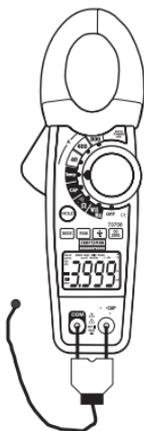
**ADVERTENCIA:** Para evitar choque eléctrico, asegúrese que se ha quitado el termopar antes de cambiar a otra función de medición.
